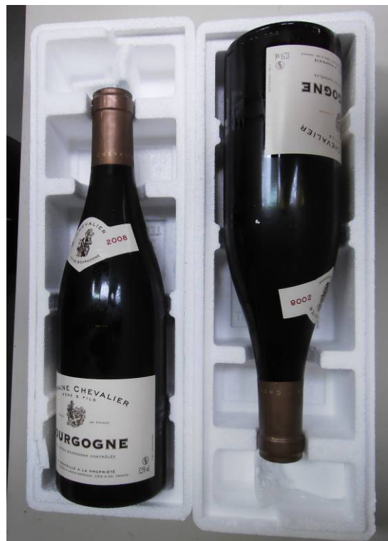
Figure 7 Exemple Coffret 2 Bouteilles après chute
