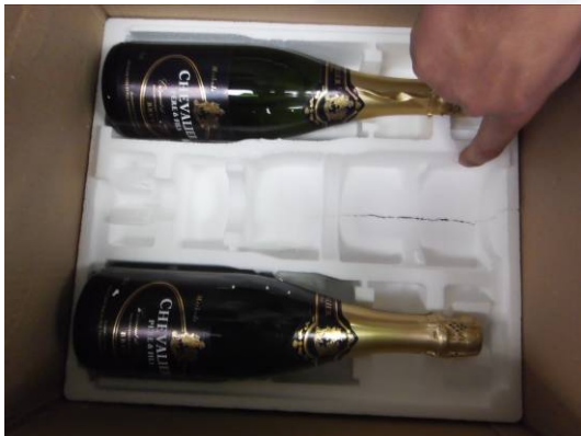
Figure 10 Exemple Coffret 12 Bouteilles après chute
