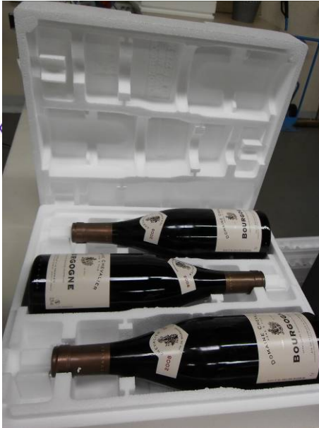
Figure 8 Exemple Coffret 3 Bouteilles après chute
