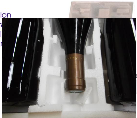
Figure 9 Exemple Coffret 3 Bouteilles après chute
