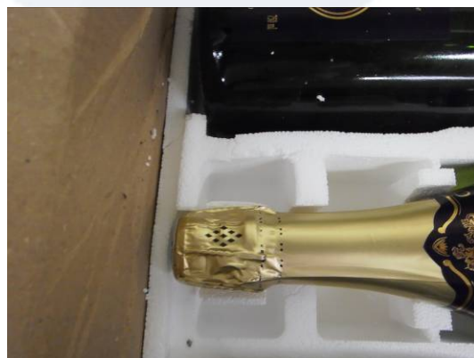
Figure 12 Exemple Coffret 12 Bouteilles après chute
