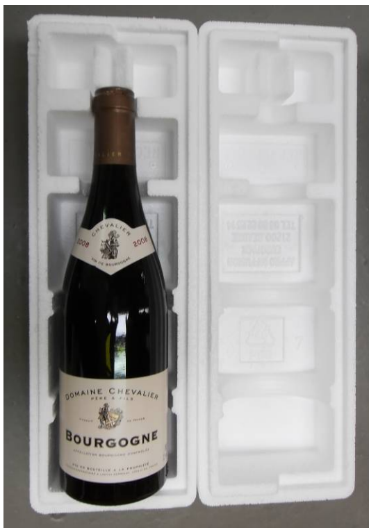
Figure 6 Exemple Coffret 1 Bouteille après chute
